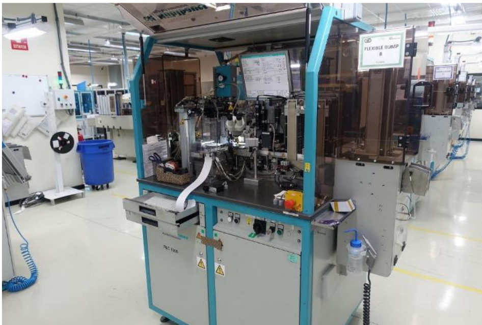
Vista geral da máquina automática para aplicação de colas ou pastas indutivas em cartões, modelo: FBC 1200.
